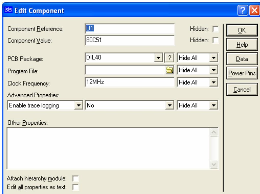
بر روی علامت program file با نام folder کلیک کنید تا پنجره ای مطابق شکل باز شود :
