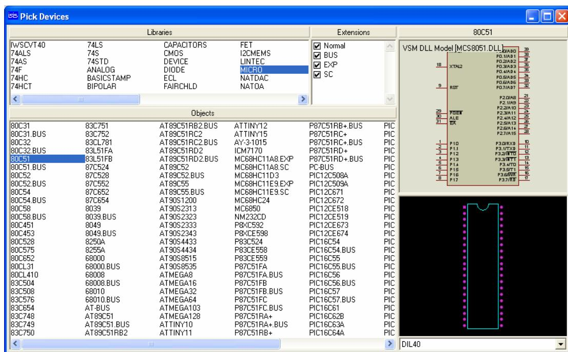
از کتابخانه شی 80C51 micro را انتخاب و بر روی آن ۲ بار کلیک کنید. شی ای با همین نام به قطعات سند شما اضافه می‌شود. کتابخانه display را انتخاب و از اشیا موجود شی LM016L را انتخاب و بر روی آن ۲ بار کلیک کنید. این پنجره را بسته و به سند اولیه بر می‌گردیم.
