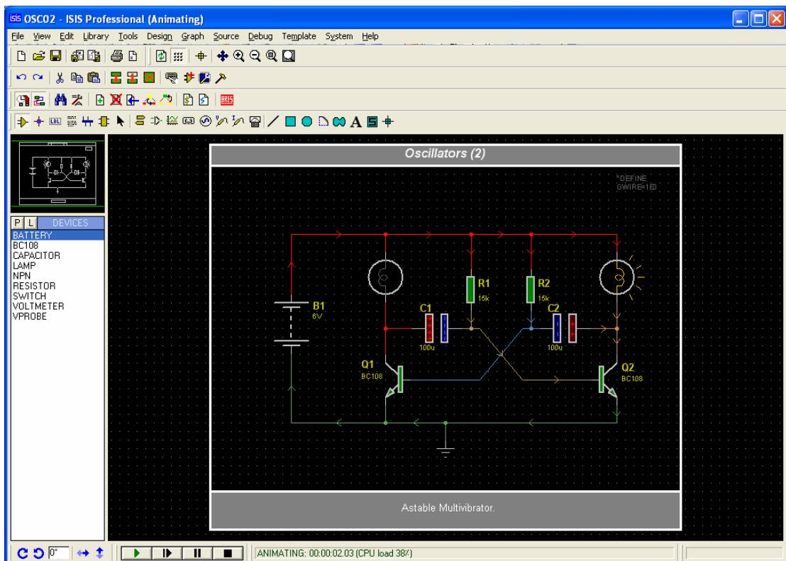
همانطور که در شکل مشخص است این یک مدار مولتی ویبراتور است که برای نشان دادن نحوه شارژ و درشارژ شدن خازن ها و نحوه نوسان مدار مولتی ویبراتور طراحی شده است .
